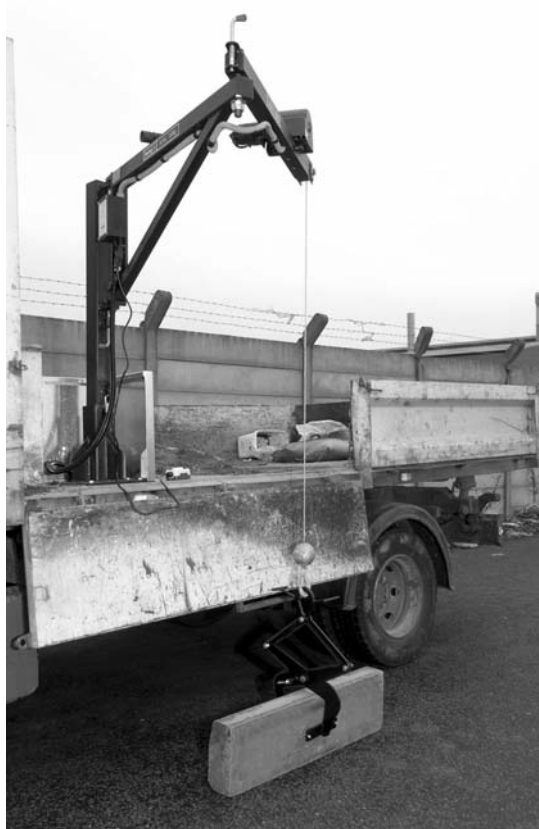
Rysunek 2 Dźwig zainstalowany na przyczepie samochodu i chwytak mechaniczny
