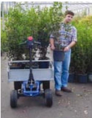
Ffigur 3 Troli hunanyredig sy'n cael ei ddefnyddio i gludo planhigion cynwysyddion mewn planhigfa
