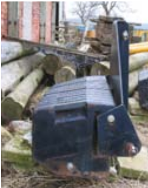
Ffigur 1 Pwysau tractor wedi'u gosod ar ffrâm fel y gellir cysylltu offer gan ddefnyddio breichiau cyswllt hydroilig
