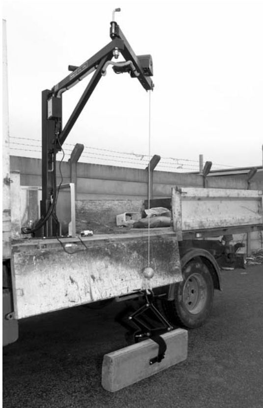
Figura 2 Macara și graifăr mecanic montate pe un vehicul
